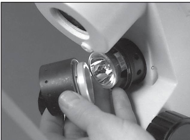
Figure 1 Unscrew the lower portion of the illuminator housing Abb. 1 Den unteren Teil des Lampengehäuses abschrauben Figure 1 Dévissez la partie inférieure du boîtier de l'éclairage en prenant soin de garder intacte la partie inférieure Figura 1 Destornille la porción inferior de la carcasa del iluminador
